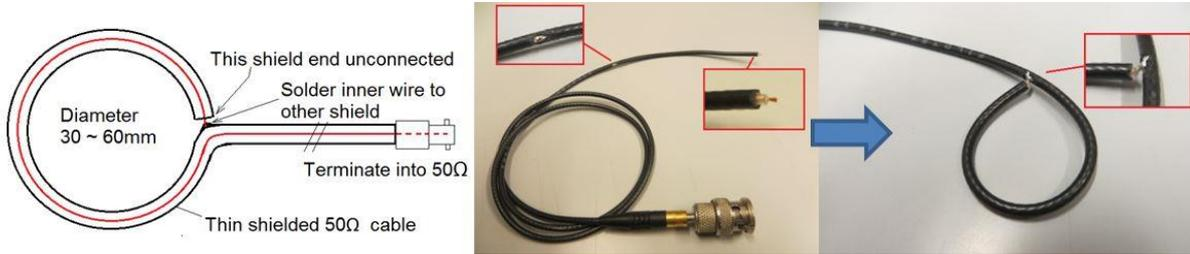
**FIGURE 7 : HIGH FREQUENCY CURRENT LOOP**
